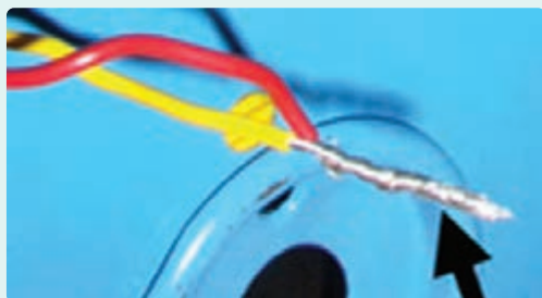
سیم‌های آلومینیومی که روی هم پیچیده شده‌اند.
