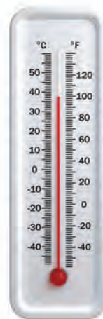
شکل ۱-۴ یک نمونه دماسنج الکلی
